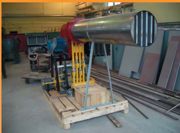
ООО «Камэнергостройпром», г. Нижнекамск. Производство керамзита, горелка МДГГ-800Б с удлиненным насадком для прохождения зоны загрузки.
