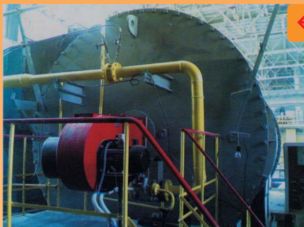
ООО «Камэнергостройпром», г. Нижнекамск. Производство керамзита, горелка МДГГ-800Б с удлиненным насадком для прохождения зоны загрузки.
