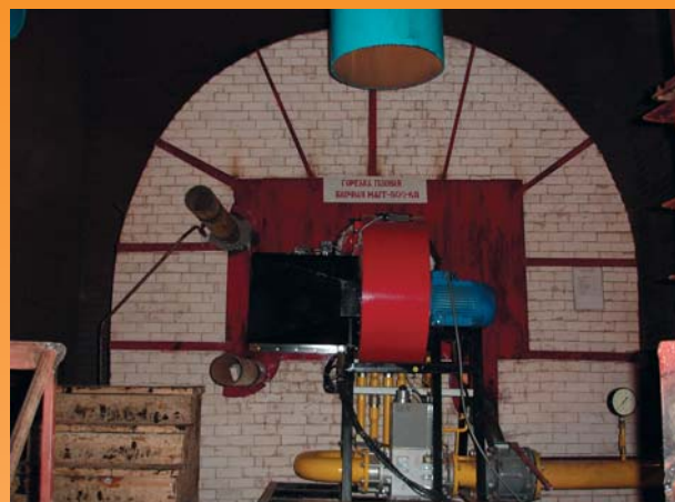
ООО «Камэнергостройпром», г. Нижнекамск. Производство керамзита, горелка МДГГ-800Б с удлиненным насадком для прохождения зоны загрузки.
