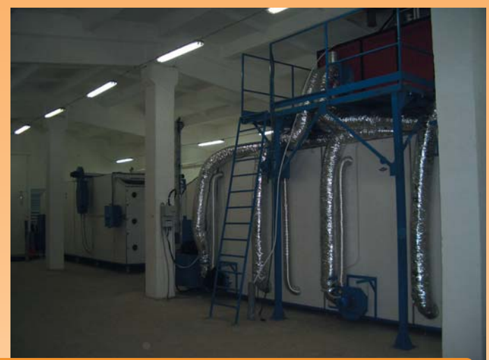
Пензенская область. Линия макаронных изделий, воздухонагреватель АГОР-315 с температурой сушильного агента 150\text{ }^{\circ}\text{C} .
