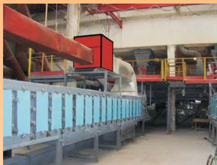
Туннельные сушила. Производство шифера, гипсобинтов. Воздуонагреватели серии АГОС.
