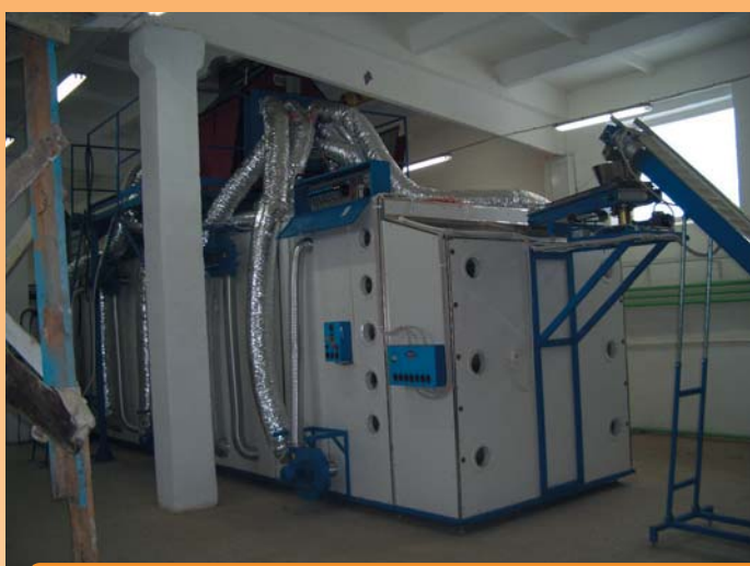
Пензенская область. Линия макаронных изделий, воздухонагреватель АГОР-315 с температурой сушильного агента 150\text{ }^{\circ}\text{C} .
