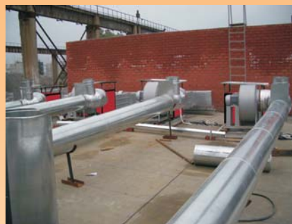
Сушка гипсовых пазогребневых плит. Воздуонагреватели серии АГОС-4.
