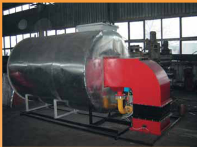
Побужский ферроникелевый комбинат. Тепловая обработка ферроникелевого концентрата. Высокотемпературный АГОС.
