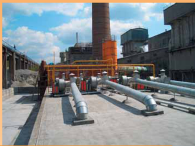
ООО «Гипсобетон», Московская область, г. Видное. Сушка гипсовых пазогребневых плит, АГОС-4, 8шт.
