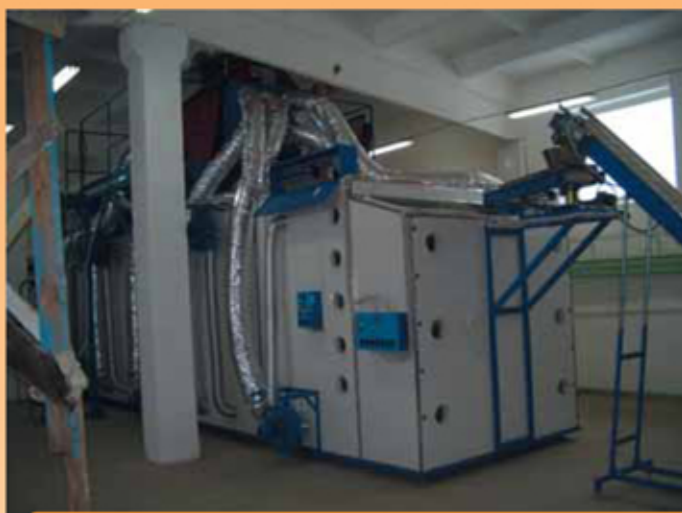
Пензенская область. Линия макаронных изделий, воздухонагреватель АГОР-315 с температурой сушильного агента 150 °С.
