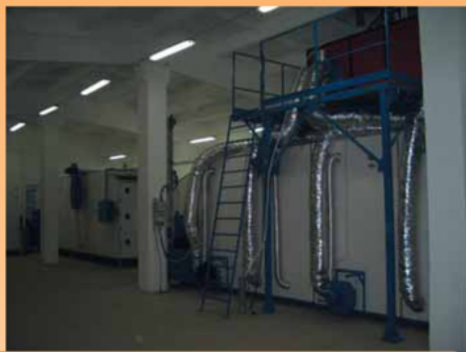
Пензенская область. Линия макаронных изделий, воздухонагреватель АГОР-315 с температурой сушильного агента 150 °С.
